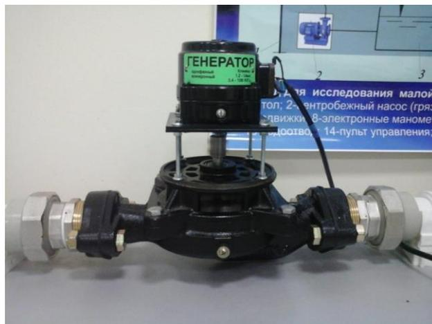
Рисунок 2.6 - Рабочее состояние узла «гидротурбина-генератор»
