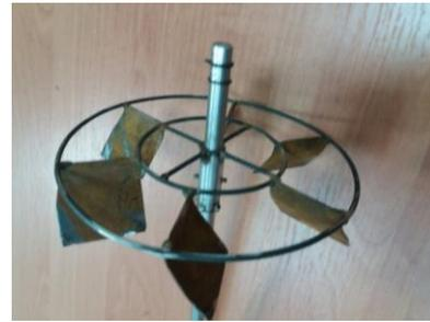
Рисунок 1.8 - Разработанная гидротурбина лопаточного типа с одинарным ободком на валу (угол расположения лопаток 45 градусов)
