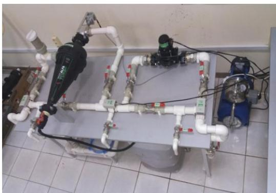
Рисунок 1.6 - Общий вид доработанного лабораторного стенда для испытания новой конструкции мини - ГЭС
