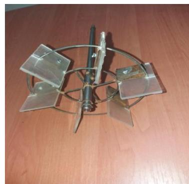
Рисунок 1.10 - Виды лопаток турбины из оргстекла с удлиненной длиной
