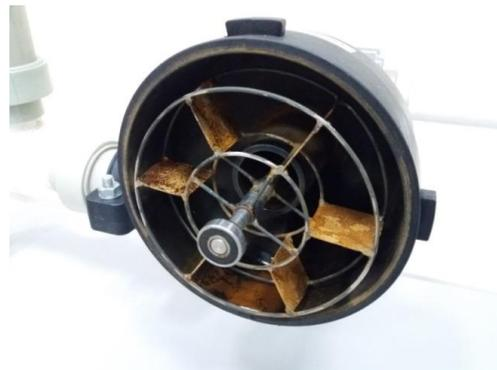
Рисунок 1.9 - Вид гидротурбины, установленной в цилиндрической части гидроциклона
